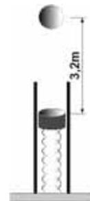
Adotando  $g = 10\text{ m/s}^2$  e desprezando o atrito no sistema, pode-se afirmar que a velocidade ( $v$ ) que a esfera atinge o mecanismo, em m/s, e a contração da mola ( $x$ ), em metros, valem:
